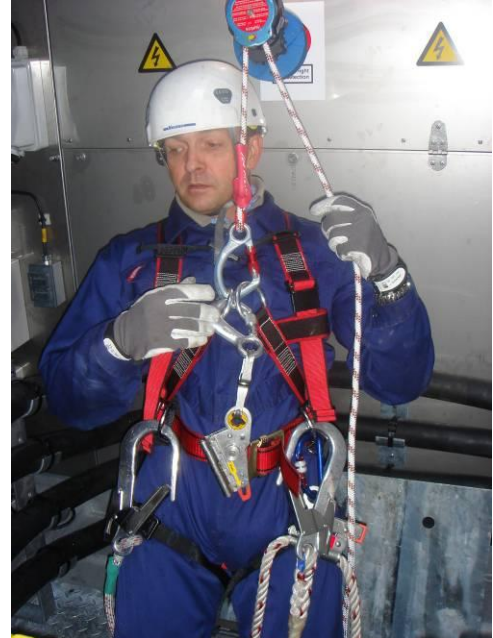
Accrocher l'équipement de descente d'urgence aux anneaux en D situés à l'avant du harnais et tirer sur la corde pour la tendre.
